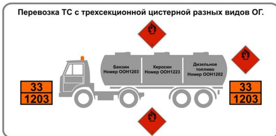
При перевозке нескольких веществ, на ТС устанавливаются таблички обозначающие вещество с самой низкой температурой вспышки.
