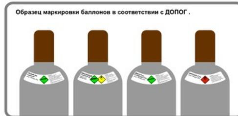
Маркировка ТС перевозящего совместно баллоны с **разными веществами**. Смотри в разделе "Совместная перевозка в баллонах"
