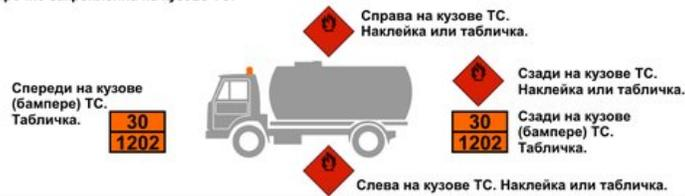
Ниже приведены примеры равноценных вариантов маркировок в соответствии с ДОПОГ (действительно для всех опасных грузов).
